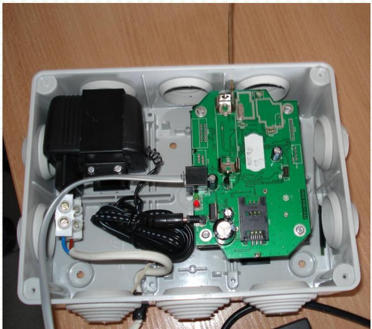
Фото 1. Концентратор до модернизации.
